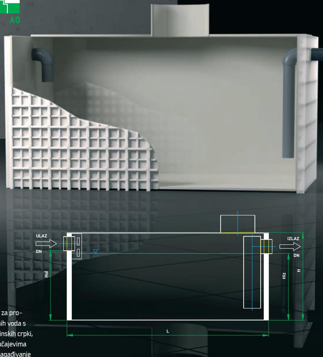
Upotrebljavaju se za pročišćavanje otpadnih voda s parkirališta, benzinskih crpki, itd., odnosno u slučajevima kada je prisutno zagađivanje oborinske ili procesne vode zauljenim tekućinama, a recipijent je kolektor-kanalizacija. Rade na principu razlike specifičnih težina tekućina.
