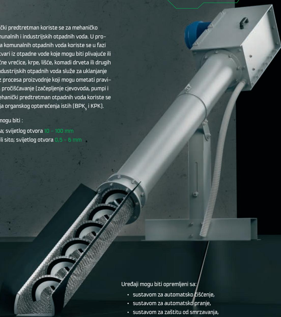
Grube rešetke primjenjuju se za pročišćavanje komunalnih otpadnih voda kod uređaja kapaciteta 200 – 5000ES, kao i u nekim granama industrije gdje ovakav tretman zadovoljava predviđene izlazne parametre. Grube rešetke mogu biti ručne i automatske. Kod ručnih rešetki prikupljeni se otpad uklanja ručno dok automatske posjeduju sustav za automatsko vađenje otpada i odlaganje u odgovarajući spremnik.
