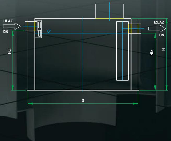
Upotrebljavaju se za pročišćavanje otpadnih voda s parkirališta, benzinskih crpki, itd., odnosno u slučajevima kada je prisutno zagađivanje oborinske ili procesne vode zauljenim tekućinama, a recipijent je kolektor-kanalizacija. Rade na principu razlike specifičnih težina tekućina.
